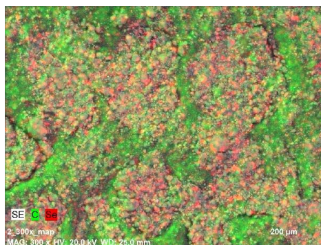
Rys. 1. Obrazowanie SEM-EDX próbki JP VIII w powiększeniu 200 \mu\text{m} .
